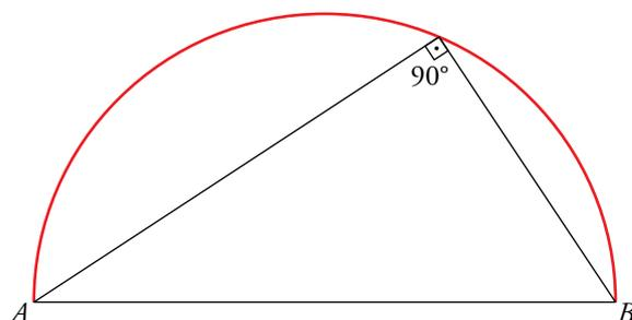
La circunferencia de diámetro  $AB$  (el arco rojo) es el lugar geométrico de los puntos desde los cuales se ve el segmento  $AB$  bajo un ángulo de  $90^\circ$ . Se llama arco capaz de  $90^\circ$  para el segmento  $AB$ .
